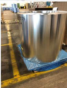
Funda de bobina VCI ZERUST® a medida, colocada sobre la plataforma antes de colocar la bobina en la plataforma.
