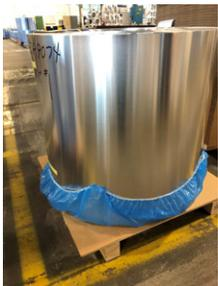
La funda de bobina VCI ZERUST® se sube sobre la parte inferior de la bobina.
