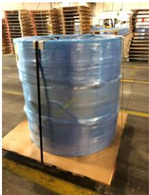
El embalaje terminado incluye una funda de bobina VCI ZERUST® en la parte inferior y superior de la bobina. Luego, el operador utiliza película estirable VCI ZERUST® para envolver y cerrar completamente el embalaje antes de usar bandas para asegurar la bobina a la plataforma.
