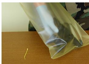
Coloque el equipo dentro de la Bolsa de Protección Anticorrosiva ZERUST® ICT® y tire de los lados de la bolsa para envolver completamente el equipo.
