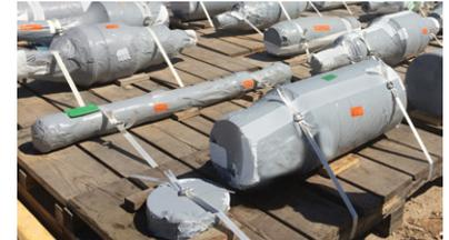
La Película Encogible VCI y la Película Encogible para Exteriores ZERUST® se adaptan a los objetos.
